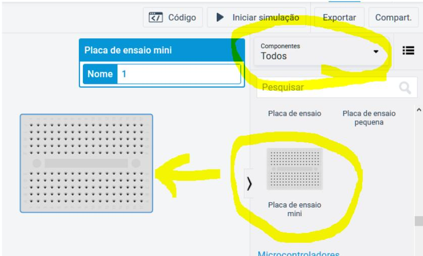
Figura 1.9 – Colocando uma Placa de ensaio mini no Tinkercad.
