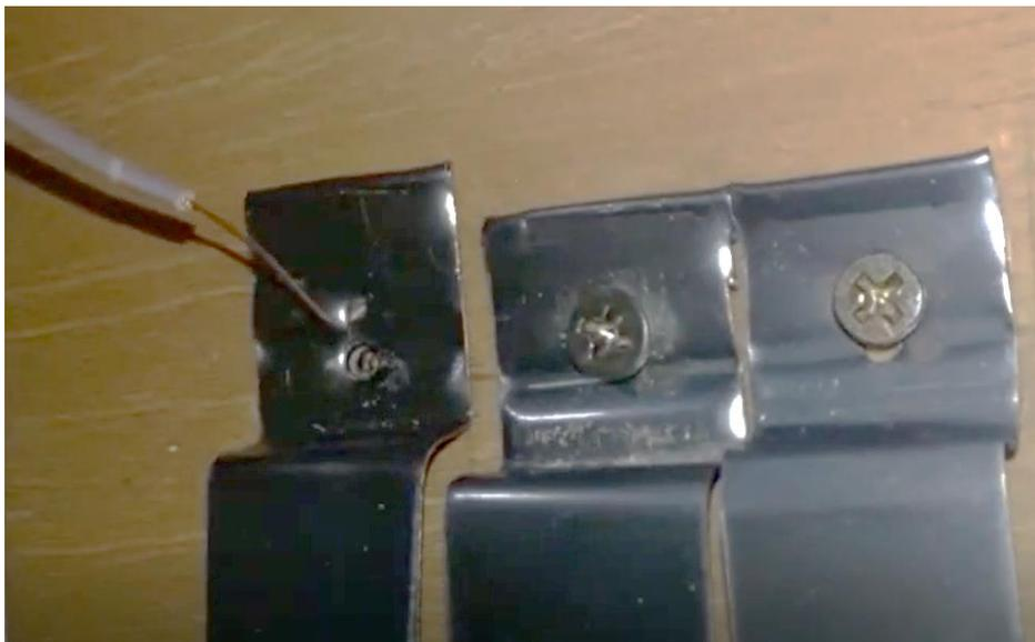
Figura 4.8 – Inserindo a ponta do cabo no orifício da placa e do compensado
