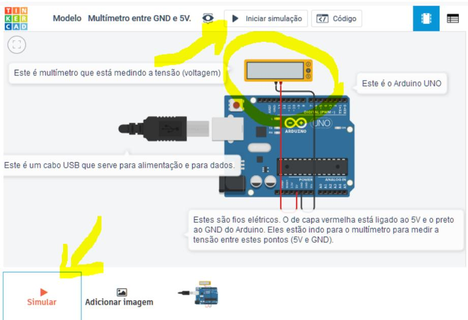
Figura 1.5 – Modelo com medição de tensão no Arduino
