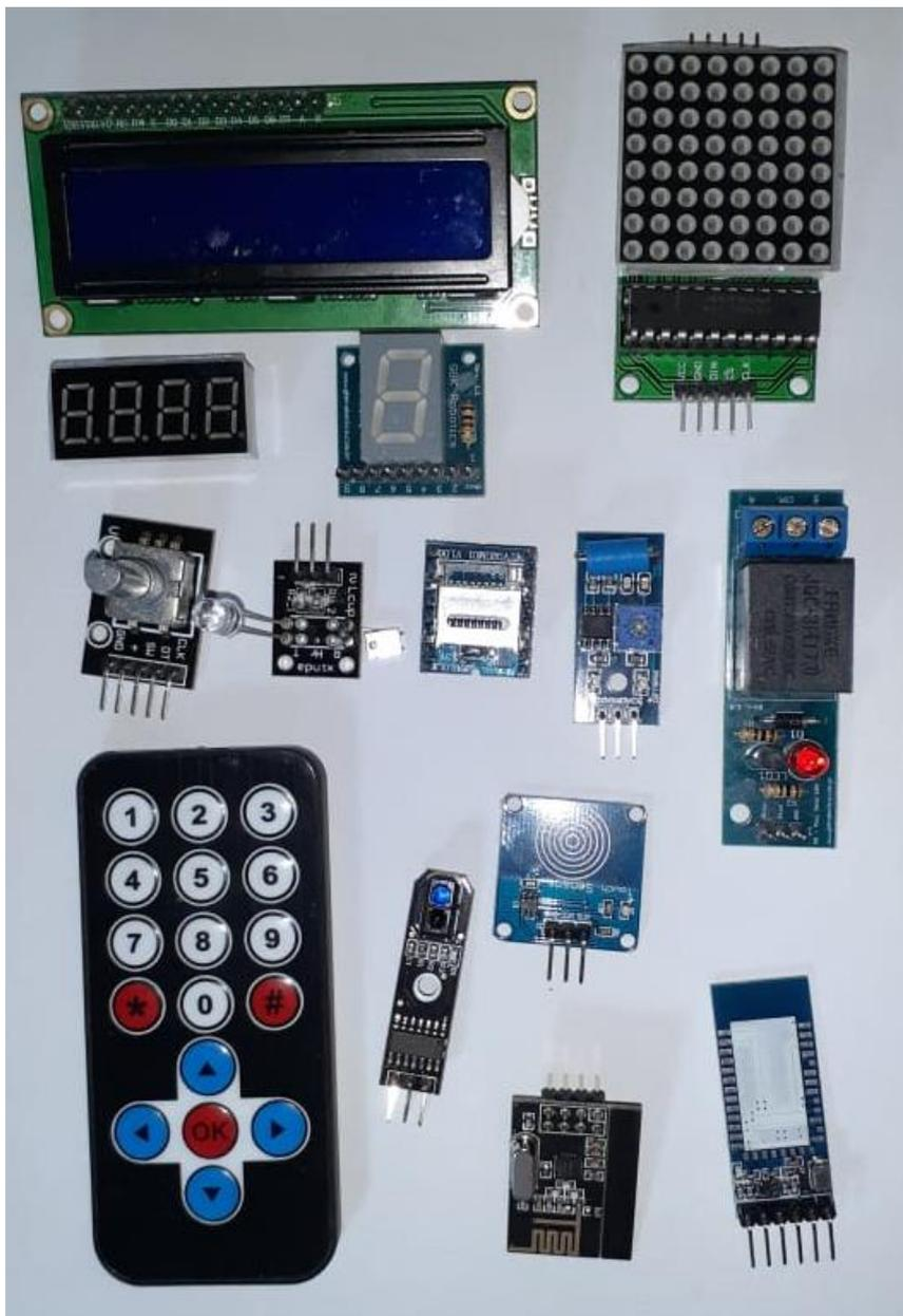
Figura 1.29 – Diversos sensores, atuadores e módulos para o Arduino
