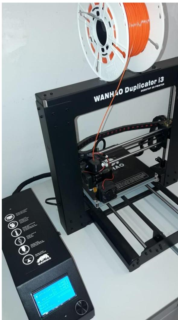
Figura 2. Impressora 3D com filamento.
